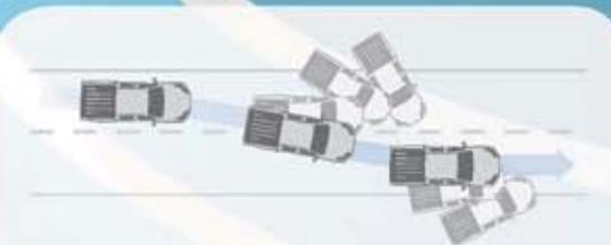
**Control electrónico de diferencial (VDC).** El VDC controla la dirección, la frenada y la estabilidad del vehículo y, cuando es necesario, reduce la potencia y frena de forma individualizada cada rueda para que sigas la trazada deseada.
