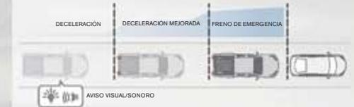
**Sistema anti-colisión frontal (FEB).** El radar en el parachoques delantero mide la distancia que hay con el coche de delante. Si detecta riesgo de colisión emitirá un aviso visual y sonoro. Si no frenas lo suficiente, el vehículo lo hará por ti para evitar el accidente. El sistema funciona a cualquier velocidad y garantiza la frenada sin colisión hasta los 30 km/h.
