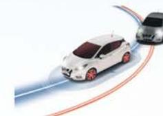
**EL CONTROL INTELIGENTE DE TRAZADA** proporciona un control de la dirección fiable en las curvas. Ajusta la presión de frenada en cada rueda de forma independiente para ayudarte a seguir una trazada óptima durante los giros.
